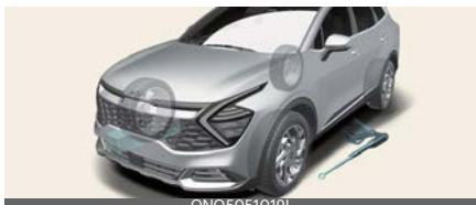
7. Ослабьте колесные гайки против часовой стрелки на один оборот каждую. Не следует снимать колесные гайки до тех пор, пока колесо не поднято с земли.
