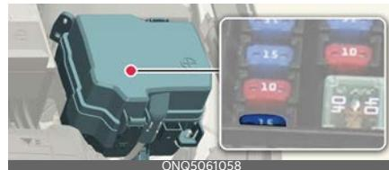
Если не работает пластинчатый плавкий предохранитель, извлеките его с помощью специальных клещей, предназначенных для замены предохранителей, расположенных в блоке предохранителей моторного отделения. После извлечения установите запасной предохранитель аналогичного номинала.
