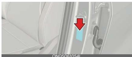
На сертификационной табличке автомобиля, закрепленной на средней стойке (см. рисунок), имеется идентификационный номер автомобиля (VIN).
