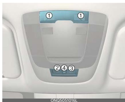
Элементы системы ЭРА-ГЛОНАСС, установленные в салоне автомобиля:
