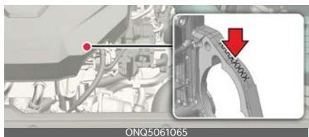
Серийный номер двигателя выбит на блоке цилиндров, как показано на рисунке.
