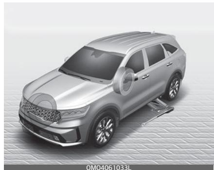
4. Достаньте колесный гаечный ключ, домкрат и запасное колесо из автомобиля.
