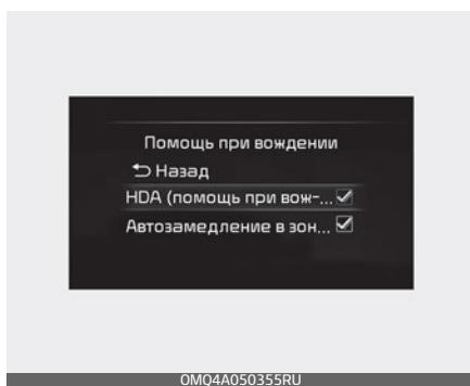
Переведите кнопку «ENGINE START/STOP» (Запуск/остановка двигателя) в положение «ON» (Вкл.) и в меню «Settings» (Настройки) выберите пункт «Driver Assistance» (Помощь водителю) → «Driving Assist» (Вспомогательная система движения), чтобы включить или отключить эти функции.
