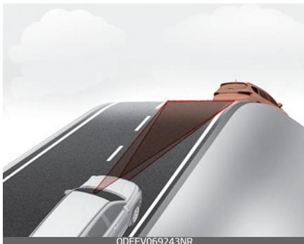
При движении на подъеме или спуске система интеллектуального круиз-контроля может не обнаружить транспортное средство, движущееся в вашей полосе, и ускорит движение до заданной скорости. Кроме того, при внезапном обнаружении движущегося впереди автомобиля скорость начнет быстро снижаться.
