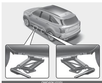
7. Установите домкрат в переднее (1) или заднее (2) подъемное положение (ближайшее к заменяемому колесу). Разместите домкрат под рамой автомобиля в обозначенной точке. Положения для упора домкрата — это прикрепленные к раме автомобиля пластины с двумя фиксаторами и наплывом.
