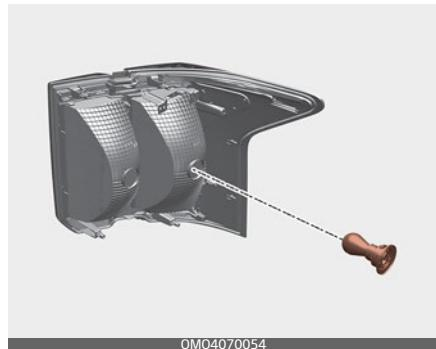
8. Извлеките лампу из патрона, вдавив ее и повернув против часовой стрелки до положения, в котором ее выступы совместятся с прорезями в патроне.
