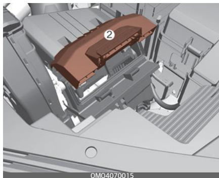
3. Поверните фиксирующий рычаг на фильтре и ослабьте замок.
