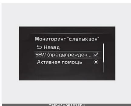
Когда кнопка запуска/остановки двигателя находится в положении «ON» (Вкл.), выберите в меню «Settings» (Настройки) пункт «Driver Assistance» (Помощь водителю) → «Blind-Spot Safety» (Мониторинг слепых зон) → «Safe Exit Assist» (Контроль безопасного выхода), чтобы включить вспомогательную систему обеспечения безопасного выхода, и отмените выбор для ее отключения.
