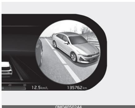
Когда включен сигнал поворота, монитор отображения «слепых зон» отображает на приборной панели заднюю непросматриваемую зону рядом с автомобилем для помощи в безопасной смене полосы движения.
