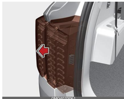
5. Извлеките узел задней комбинированной фары из кузова автомобиля.
