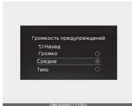
Чтобы изменить уровень громкости вспомогательной системы движения по автостраде на «High» (Высокий), «Medium» (Средний), «Low» (Низкий) или «Off» (Выкл.), переведите кнопку «ENGINE START/STOP» (Запуск/остановка двигателя) в положение «ON» (Вкл.) и в меню
