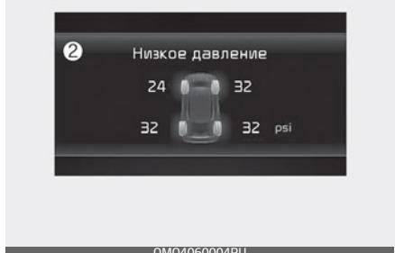
1. Сигнал низкого давления в шинах / индикатор неисправности системы TPMS.
