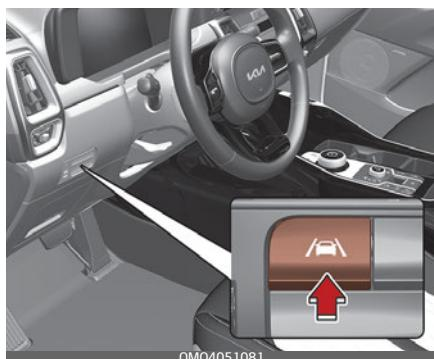
Чтобы включить систему удержания полосы, переведите кнопку «ENGINE START/STOP» (Запуск/остановка двигателя) в положение «Вкл.» и нажмите расположенную на приборной панели кнопку «Lane Safety» (Безопасность движения по полосе). На приборной панели загорается белый световой индикатор (/
