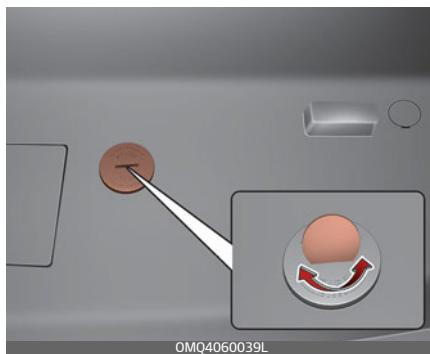
Запасное колесо хранится под днищем автомобиля, прямо под багажным отделением.
