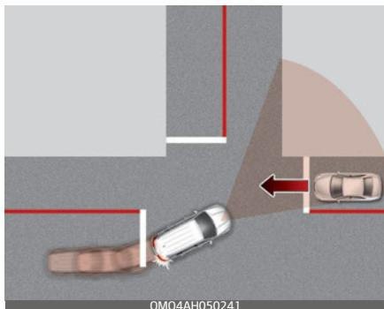
Функция Junction Turning (Поворот на перекрестке) применяет экстренное торможение, чтобы избежать столкновения со встречным транспортным средством, движущимся на соседней полосе, при его повороте на перекрестке налево с включенным сигналом поворота.
