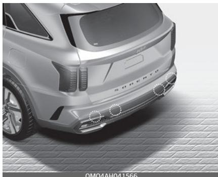
Задние ультразвуковые датчики, расположенные внутри заднего бампера, служат для обнаружения объектов позади автомобиля. Если датчики покрыты снегом, каплями дождя и т. п., это может отрицательно повлиять на работу датчиков, и система предотвращения столкновения при парковке задним ходом будет работать некорректно. Всегда поддерживайте чистоту заднего бампера.
