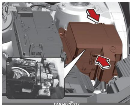
Если не работает пластинчатый плавкий предохранитель, извлеките его с помощью специальных клемм, предназначенных для замены предохранителей, расположенных в блоке предохранителей моторного отделения. После извлечения установите запасной предохранитель аналогичного номинала.
