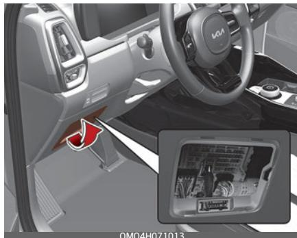
3. Извлеките предположительно неисправный предохранитель. Для этого воспользуйтесь специальным приспособлением, которое находится в основном блоке предохранителей в моторном отсеке.
