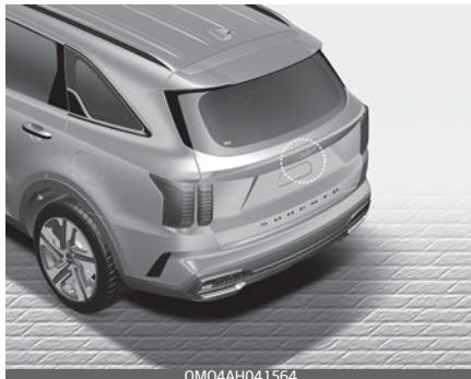
В качестве датчика для обнаружения пешеходов используется камера заднего вида. Если объектив покрыт снегом, каплями дождя и т. п., это может отрицательно повлиять на работу камеры, и система предотвращения столкновения при парковке задним ходом будет работать некорректно. Всегда следите за чистотой объектива камеры.
