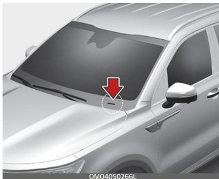
Номер VIN также указан на табличке, прикрепленной к верхней части приборной панели. Номер на табличке можно легко разглядеть снаружи через лобовое стекло.
