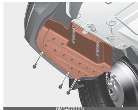
3. Ослабьте пластиковые фиксирующие винты и снимите крышку под панелью.
