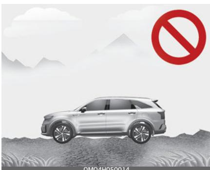
Работа интеллектуальной системы дистанционной парковки может быть отменена, если автомобиль пробуксовывает или не может продолжать движение из-за состояния дорожного покрытия, например на гравийном или булыжном участке.
