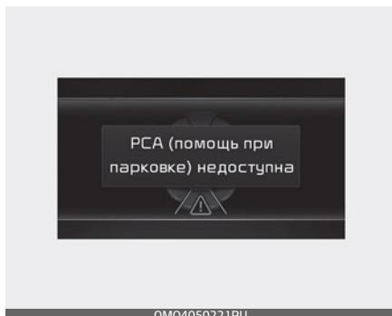
Если система предотвращения столкновения при парковке задним ходом или другие связанные с ней функции работают неправильно, на приборной панели появится предупреждающее сообщение и функция автоматически отключится. Рекомендуется проверить автомобиль у официального дилера Kia или в партнерской сервисной компании.
