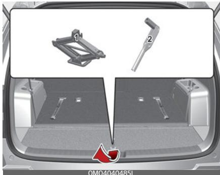
Домкрат и колесный гаечный ключ хранятся в багажном отсеке.
