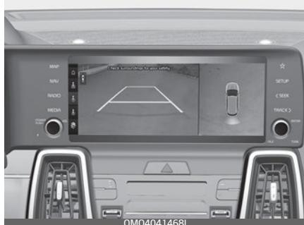
Камера кругового обзора служит для помощи при парковке, позволяя водителю видеть обстановку вокруг автомобиля.
