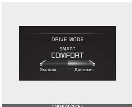
На экране отображается режим движения, выбранный водителем, и датчик стиля вождения водителя, демонстрирующий стиль вождения водителя.
