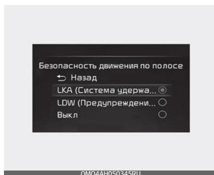
После переключения кнопки «Engine Start/Stop» (Запуск/остановка двигателя) в положение «ON» (Вкл.) перейдите в меню «Settings» (Настройки) и выберите «Driver Assistance» (Помощь водителю) → «Lane Safety» (Безопасность на полосе), чтобы
