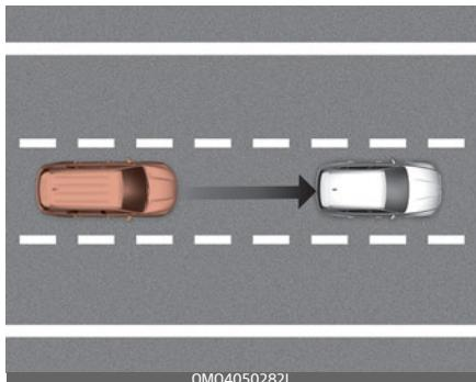
Система помощи при вождении на магистрали разработана для обнаружения транспортных средств и полос движения и соблюдения дистанции до движущегося впереди транспортного средства, установленной скорости и удержания автомобиля в полосе движения при движении по автостраде (или шоссе).
