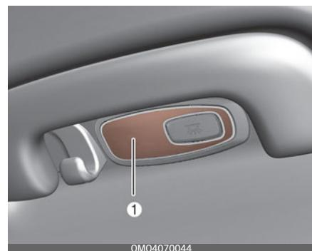
Если лампа личного освещения (светодиодная) (1) не работает, следует проверить автомобиль в специализированной мастерской.
