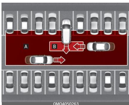
«А»: рабочий диапазон функции предупреждения об опасности столкновения при движении задним ходом
