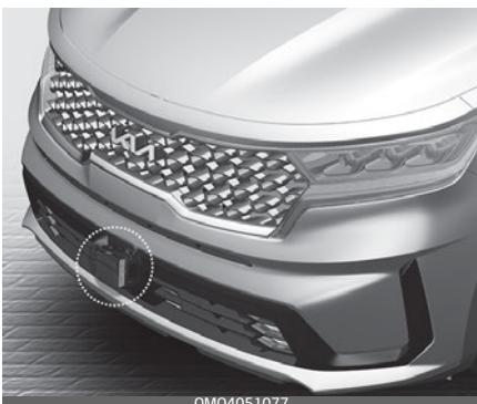
Камера фронтального обзора и передний радар используются в качестве датчика обнаружения движущихся впереди транспортных средств.
