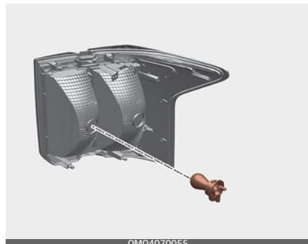
8. Извлеките лампу из патрона, вдавив ее и повернув против часовой стрелки до положения, в котором ее выступы совместятся с прорезями в патроне.
