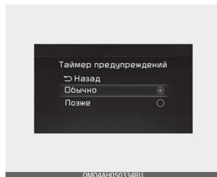
Переведите кнопку «ENGINE START/STOP» (Запуск/остановка двигателя) в положение «ON» (Вкл.) и в меню в меню «Settings» (Настройки) выберите пункты «Driver Assistance» (Помощь водителю) → «Warning Timing» (Таймер предупреждений), чтобы изменить первоначальную скорость выдачи предупреждений системы предотвращения столкновения с объектами, движущимися в поперечном направлении позади автомобиля.
