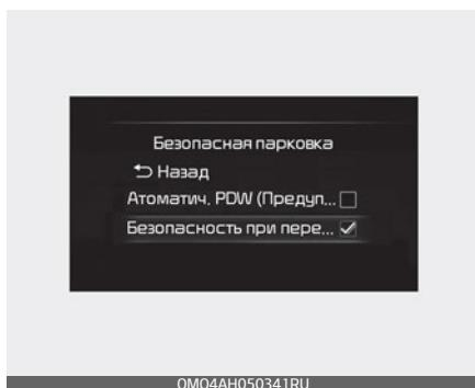
Переведите кнопку запуска/остановки двигателя в положение «ON» и в меню «Settings» (Настройки) выберите «Driver Assistance» (Помощь водителю) → «Parking Safety» (Безопасность парковки) → «Rear Cross-Traffic Safety» (Безопасность при пересеченном движении сзади), чтобы включить функцию предотвращения столкновения с объектами, движущимися в поперечном направлении позади автомобиля, или снимите флагок, чтобы отключить ее.
