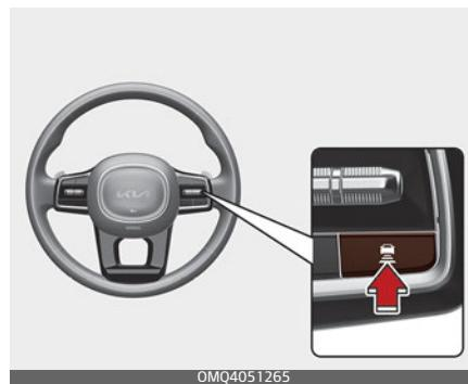
С каждым нажатием кнопки дистанция до движущегося впереди автомобиля изменяется следующим образом:
