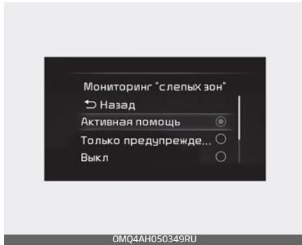
Переведите кнопку «ENGINE START/STOP» (Запуск/остановка двигателя) в положение «ON» (Вкл.) и в меню «Settings» (Настройки) выберите пункт «Driver Assistance» (Помощь водителю) → «Blind-Spot Safety» (Безопасность в слепой зоне), чтобы включить или отключить эти функции.
