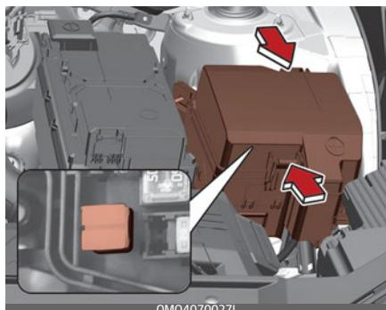
4. Проверьте извлеченный предохранитель и замените его в случае неисправности. Запасные предохранители находятся в блоке предохранителей
