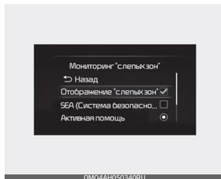
Когда кнопка запуска/остановки двигателя находится в положении «Вкл.», выберите в меню «Settings» (Настройки) пункт «Driver Assistance» (Помощь водителю) → «Blind-Spot Safety» (Мониторинг слепых зон) → «Blind Spot View» (Отображение «слепых зон»), чтобы включить монитор отображения «слепых зон», и отмените выбор для отключения функции.
