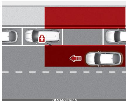
Если после остановки автомобиля и открытия пассажирской двери будет обнаружено приближающееся сзади транспортное средство, система безопасной высадки из автомобиля предупредит водителя с помощью сообщения и звукового сигнала, чтобы предотвратить столкновение.
