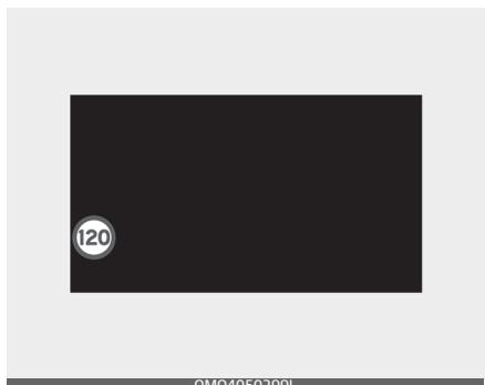
Если скорость движения превышает отображаемое на экране ограничение скорости, начнет мигать красный индикатор ограничения скорости.
