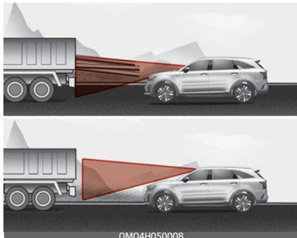
Если впереди идущий автомобиль имеет груз, выступающий сзади за пределы автомобиля, или если автомобиль имеет высокий дорожный просвет, соблюдайте особую осторожность. Система «Forward Collision-Avoidance Assist» (Предотвращение лобового столкновения) может не обнаружить груз, выходящий за габариты транспортного средства. В этих
