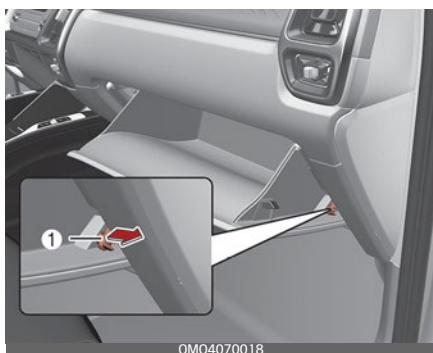
2. Не закрывая перчаточный ящик, вытяните опорную пластину.
