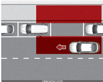
Если после остановки автомобиля и открытия пассажирской двери будет обнаружено приближающееся сзади транспортное средство, система контроля безопасного выхода предупредит водителя с помощью сообщения и звукового сигнала, чтобы предотвратить столкновение.
