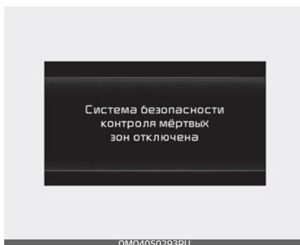
Если повторно запустить двигатель при выключенном функции, на приборной панели появится сообщение.
