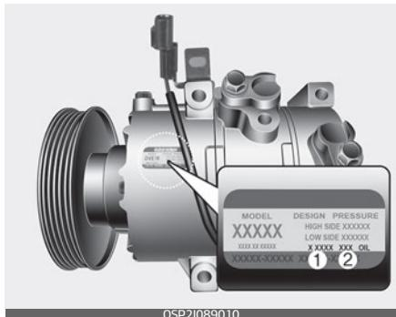
Табличка компрессора содержит сведения о типе компрессора, которым оснащен автомобиль, в частности модель, номер по каталогу поставщика, серийный номер, хладагент (1) и компрессорное масло (2).
