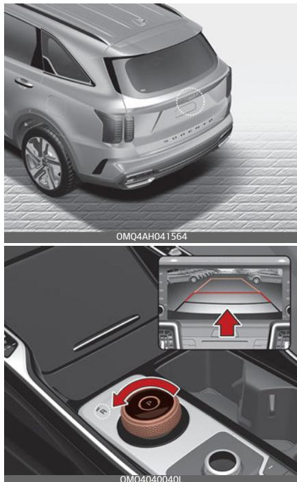
Камера заднего вида отображает область позади автомобиля для помощи при выполнении маневра парковки и движении задним ходом.
